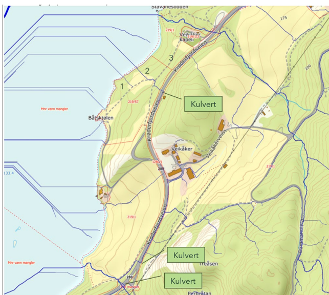
Figur 4-13 Større dreneringslinjer (nedbørsfelt > 5000 m 2 ).
