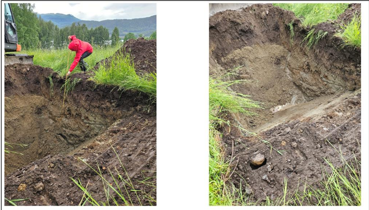
Figur 24: Sjakt 6. Finkornige masser ned til omtrent 0,8 meter. Grunnvann i bunn på omtrent 2 meters dyp.
