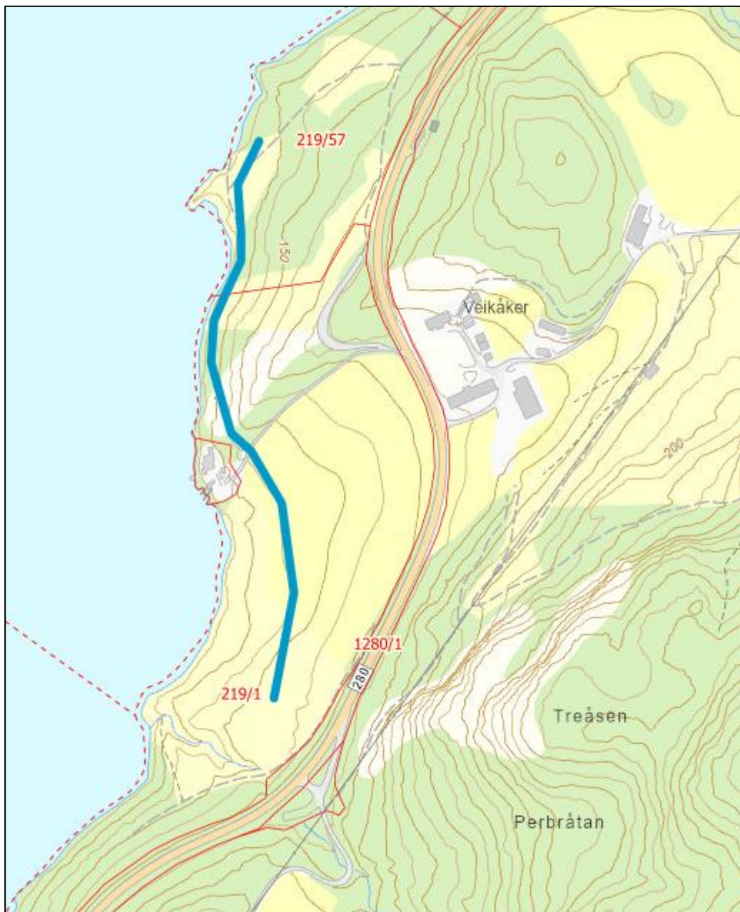
Figur 37: Infiltrasjonsanlegg på flaten ved sjakt 5 - omtrent 550 meter ledning
