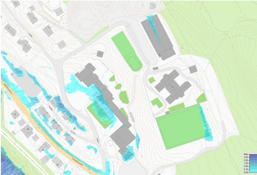
Figur 11-31: Kartutsnitt fra HEC-RAS. Hvite linjer viser vannets strømningsretning. Vanndybde er gitt i meter.
