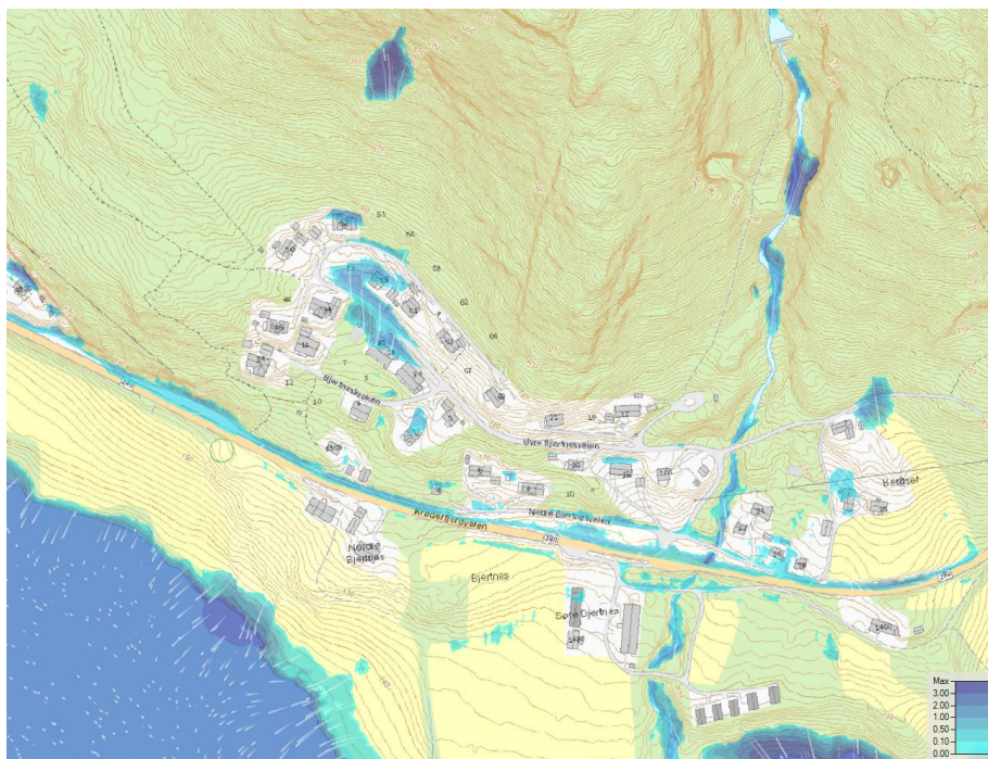
Figur 11-35: Kartutsnitt fra HEC-RAS. Hvide linjer viser vannets strømningsretning. Vanndybde er gitt i meter.
