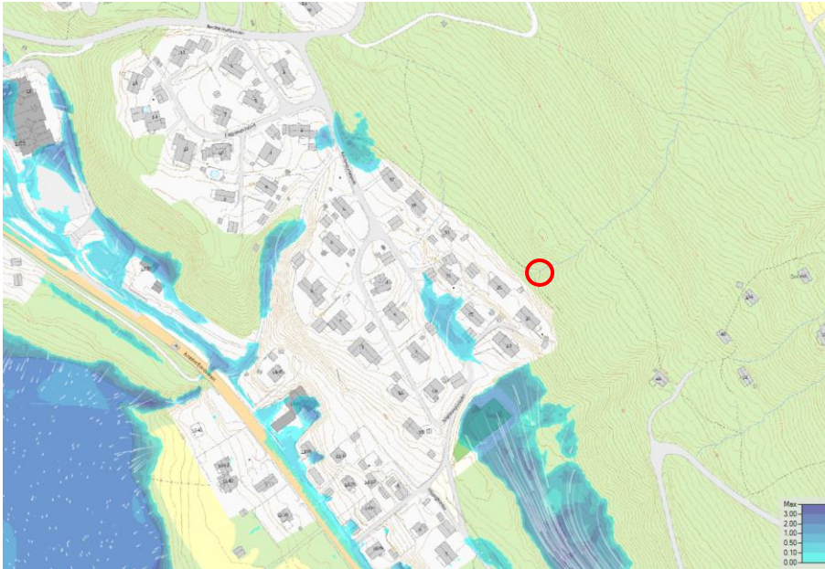
Figur 11-33: Kartutsnitt fra HEC-RAS. Hvite linjer viser vannets strømningsretning. Vanndybde er gitt i meter.
