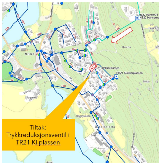
Figur 11-2: Skisse som viser trykkreduksjonsløsning for Noresund.
