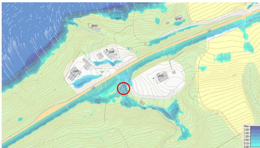
Figur 11-26: Kartutsnitt fra HEC-RAS. Hvite linjer viser vannets strømningsretning. Vanndybde er gitt i meter. Bekkeinntak markert med rød ring.
