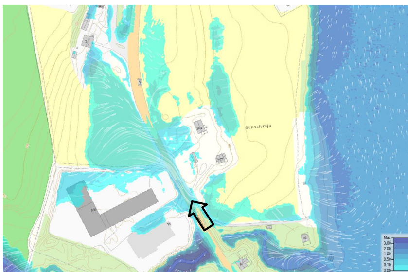
Figur 11-23: Kartutsnitt fra HEC-RAS. Hvite linjer viser vannets strømningsretning. Vannndybde er gitt i meter. Bildeposisjon og retning for Figur 11-24 er vist med sort pil.
