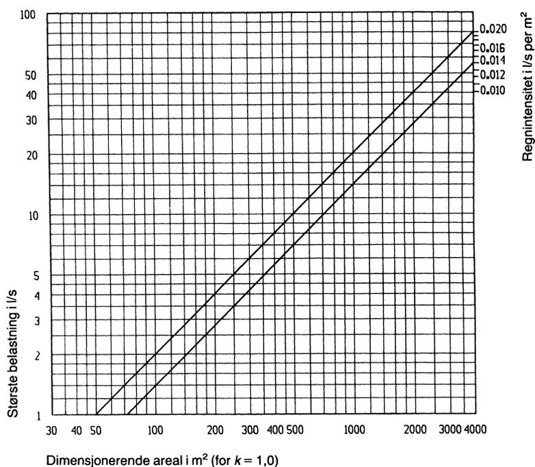
Figur 11. Overvannsmengde l/s for k = 1,0 ved forskjellige regnintensiteter
