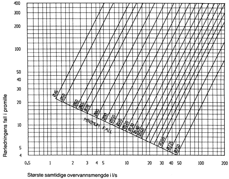
**Figur 13.** Dimensjoneringsdiagram for overvannsledninger av plast (innvendig diameter)
