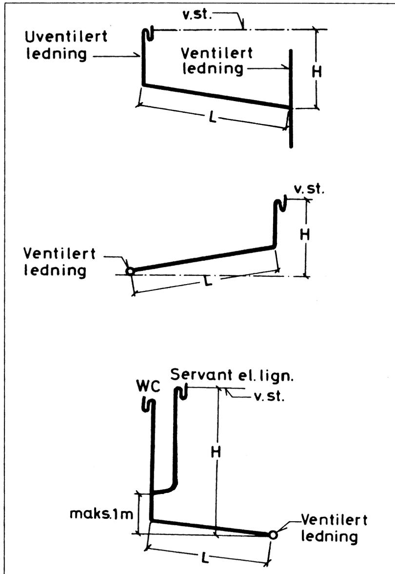
Figur 10 a. Maksimal lengde  $L$  og fallhøyde  $H$  på ikke-ventilerte spillvannsledninger
