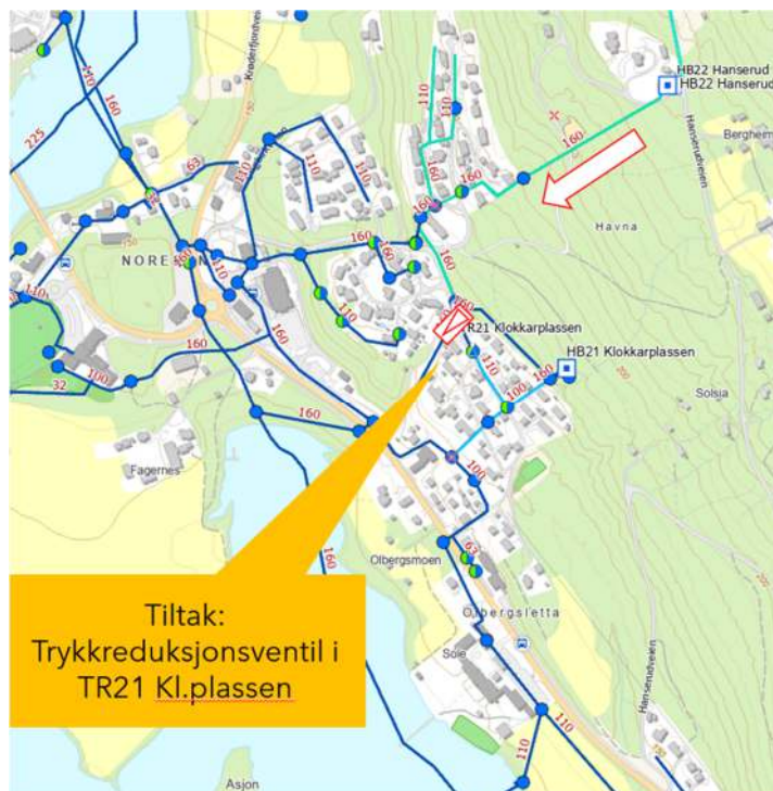
Figur 11-2: Skisse som viser trykkreduksjonsløsning for Noresund.
