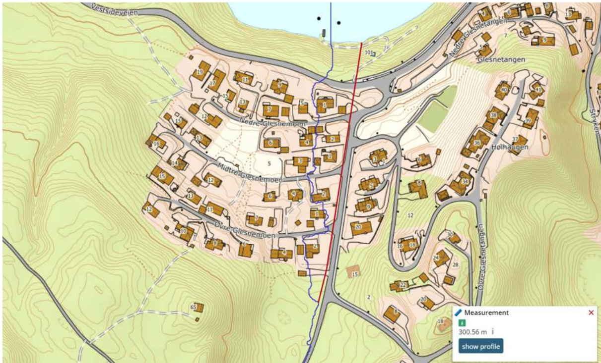
Figur 11-30: Utsnitt fra Scalgo Live. Blå linje via boligfeltet viser eksisterende teoretisk flomvei, rød linje langs Finnerudveien viser foreslått trasé for fremtidig flomvei.
