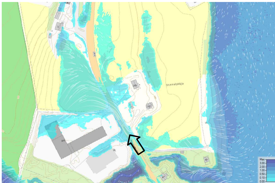
Figur 11-23: Kartutsnitt fra HEC-RAS. Hvite linjer viser vannets strømningsretning. Vanndybde er gitt i meter. Bildeposisjon og retning for Figur 11-24 er vist med sort pil.
