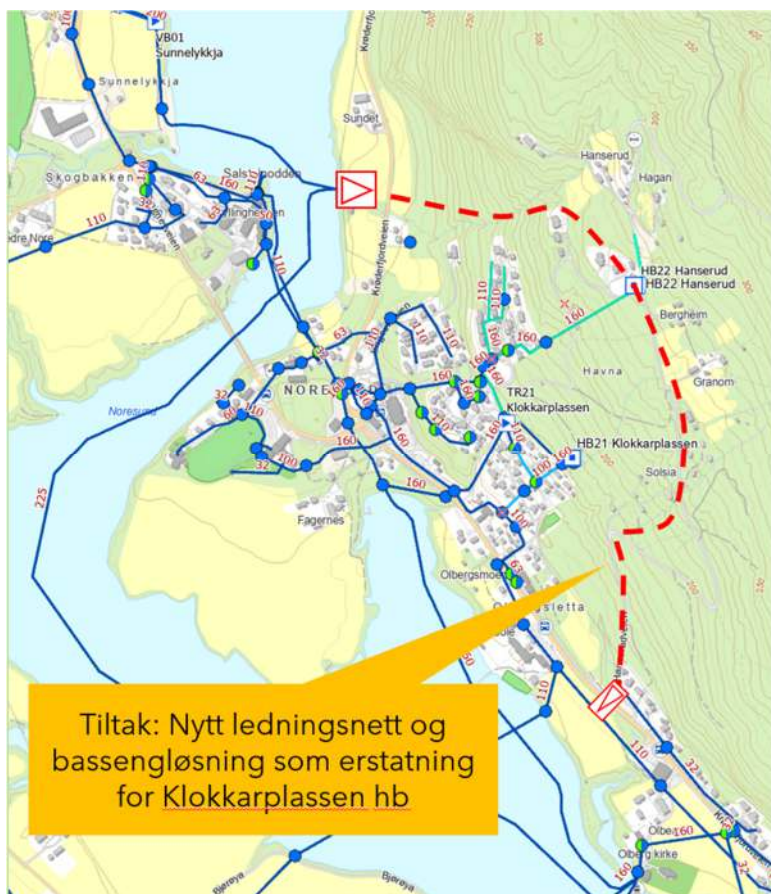
Figur 11-1: Skisse som viser mulig framtidig bassengløsning for Nore, nedre og øvre trykksone.
