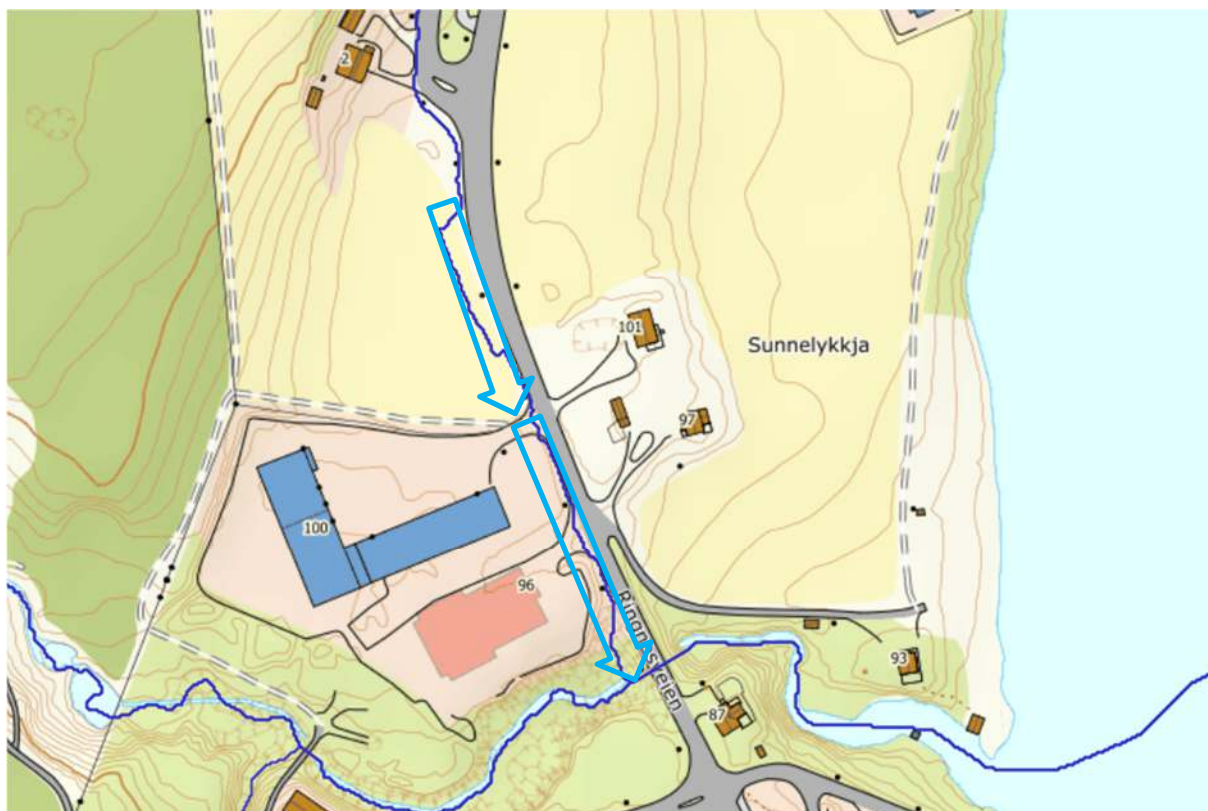
Figur 11-45: Utsnitt fra Scalgo Live. Foreslått trasé for en eventuell flomvei er vist med blå piler.
