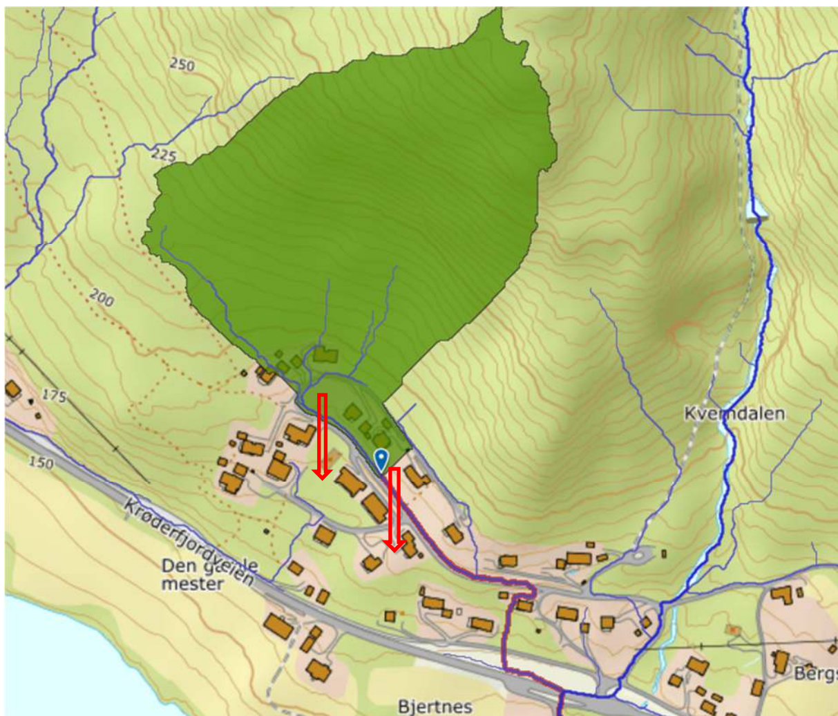
Figur 7-36: Utsnitt fra Scalgo Live. Flere dreneringslinjer går via bebygde områder ved Bjertnes. Dreneringslinjer er markert med blå linjer, rød linje viser beregnet flomvei videre fra målepunktet. Nedbørsfeltet oppstrøms er markert i grønt.
