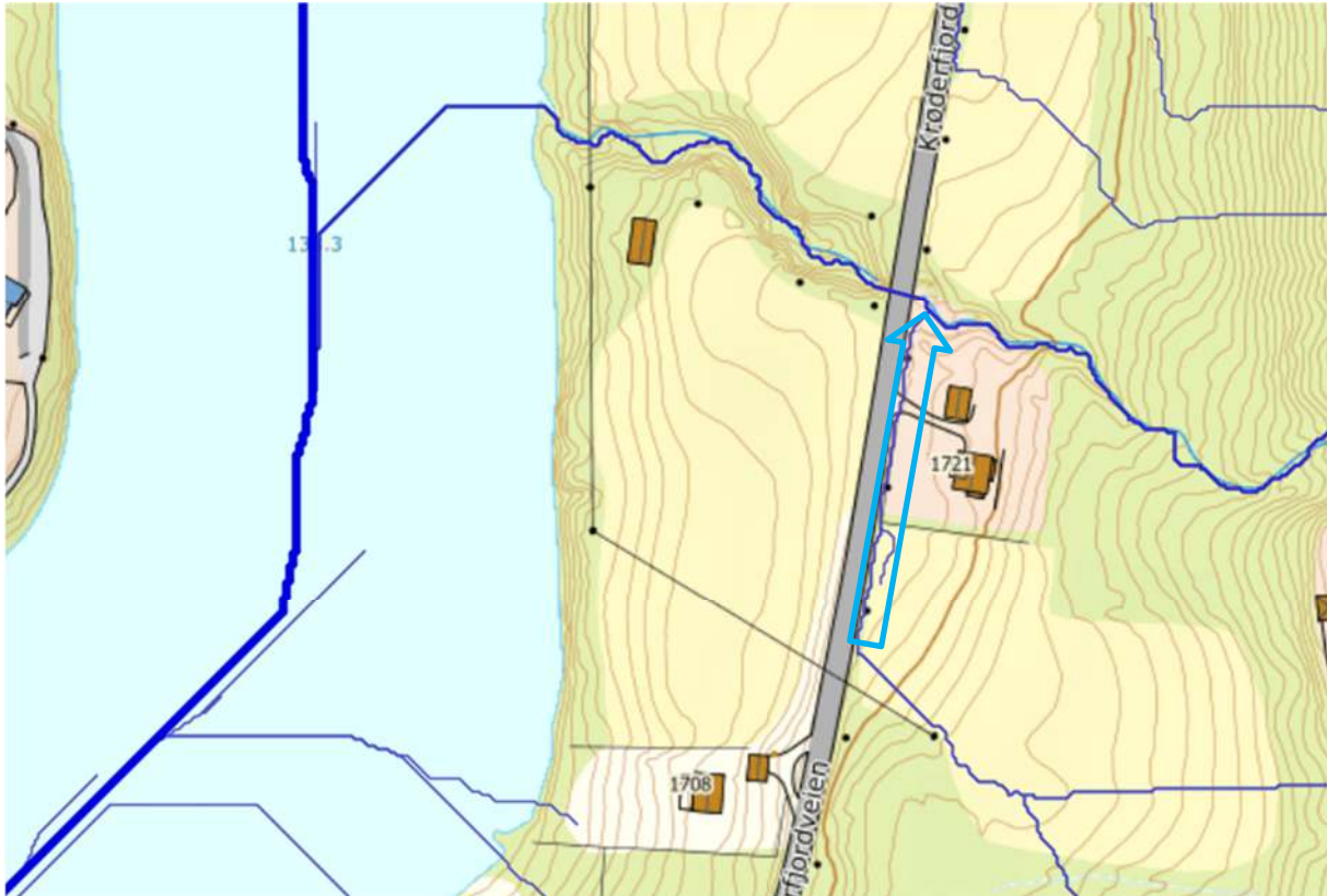
Figur 11-47: Utsnitt fra Scalgo Live. Foreslått trasé for en eventuell flomvei er vist med blå piler.
