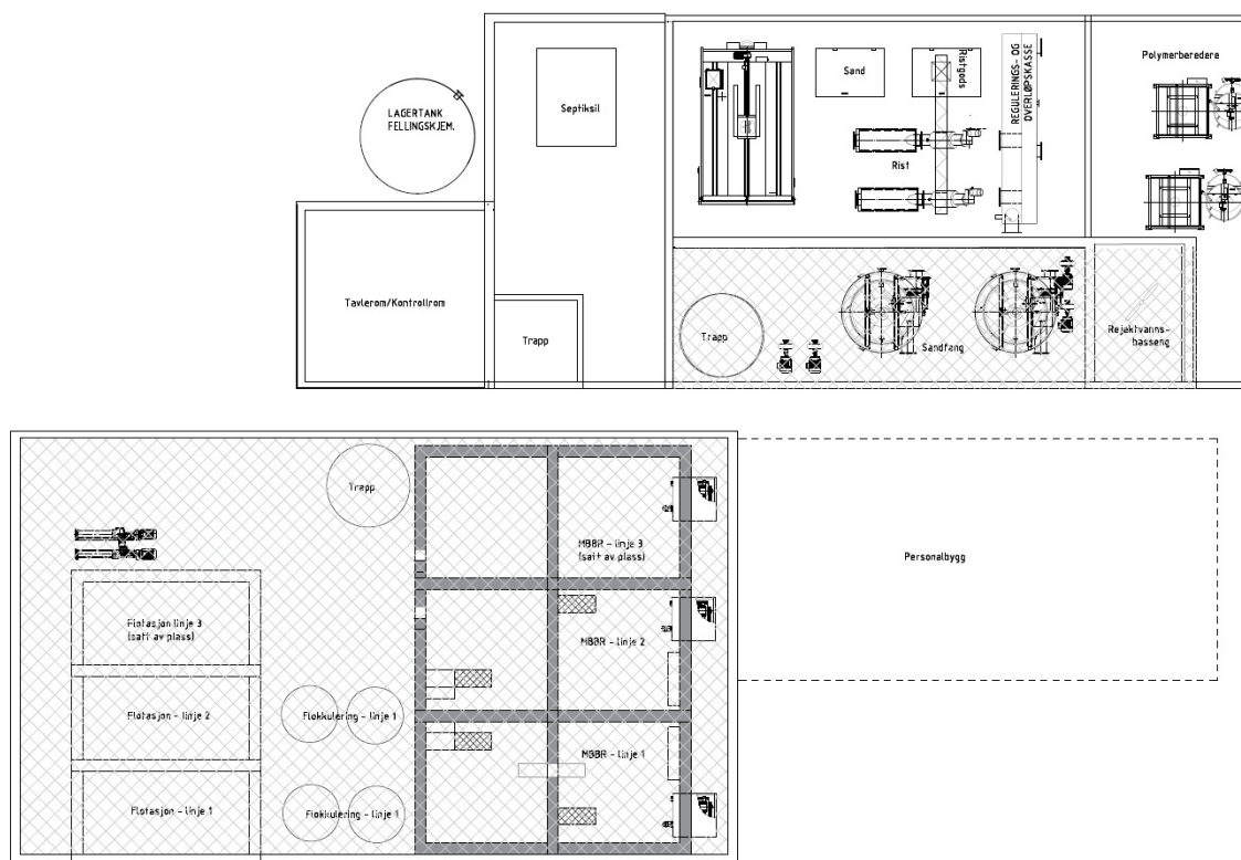
Figur 4: Planskisse av 1. etg av beregnet bygg og prosesser til alternativ 2a (flotasjon). Utforming av kjelleren er delvis synlig der hvor det er tenkt ristdekke. Det er en 2. etg. over eksisterende bygg som inneholder avvanningsmaskiner, sandvasker, VVS-rom og WC. Nybygg har kun kjeller og 1. etg. Dersom utvidelsen er med Actiflo kan denne plasseres sammen med et tynnsamlager på plass for flotasjon. Det må da også plasseres en fortykker ved septikmottaket og ved fortsatt ønske om septikmottak må dette plasseres i tilbygg, f.eks. hvor kjemikalietanken er plassert.
