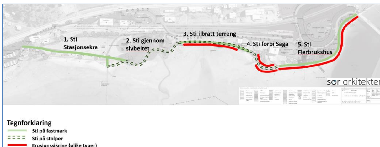
Figur 77. Illustrasjonen viser prinsipp for opparbeidelse av turveg på ulike delstrekninger (SØR arkitekter).
