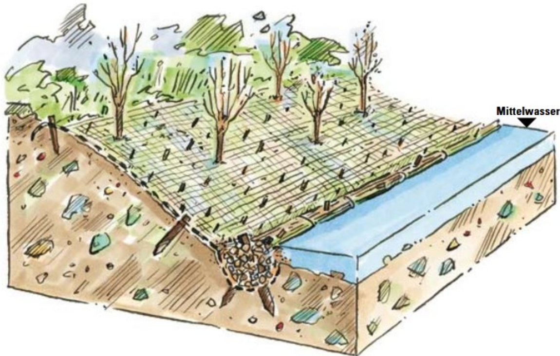
Abb. 4.38: Böschungsschutzmatte in Kombination mit Faschinen-Fußsicherung, Herstellungszustand
