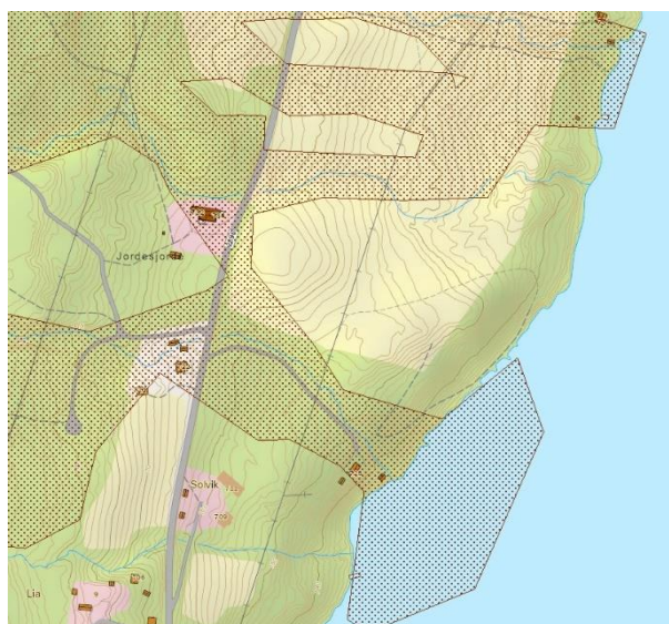
Figur 21. Viser område for jord- og flomskredfare. Ved en potensiell skredhendelse kan landområdets nordlige og søndre del bli berørt. Kilde: NVE.no / NGU.
